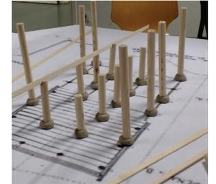
Pour pouvoir assembler les poutres et les poteaux, nous avons créé des encoches dans les poteaux.
