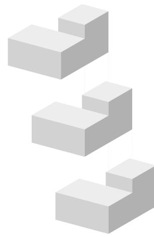
Principe d'assemblage: décaler la demie hauteur
